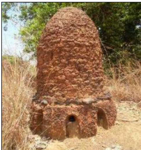
Figure 27 : Fourneau pour la métallurgie du fer. Photo S.BOUJU
